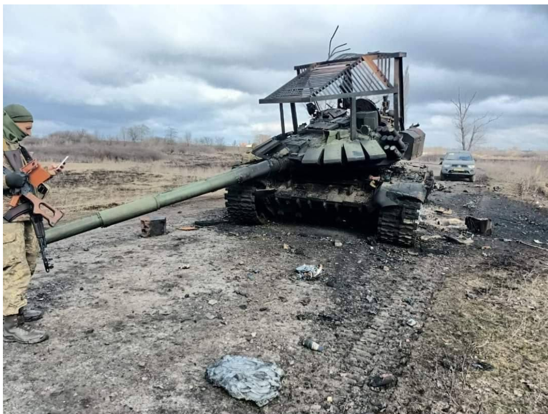
T-72B3 obr. 2016 com a ineficiente grade (grelha) sobre a torre prevista para proteção contra míssil Javelin
