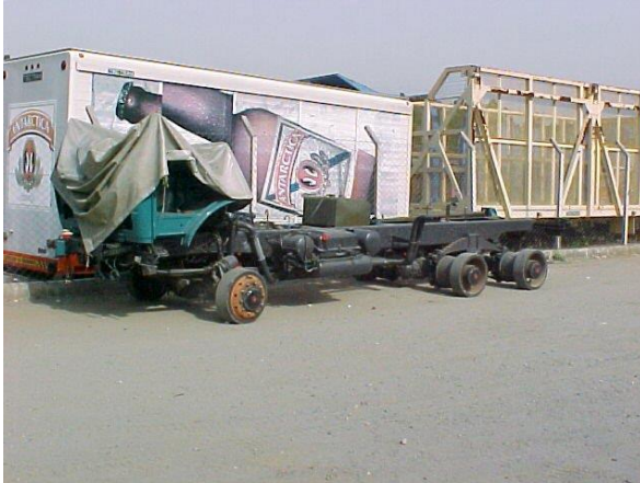
Chassis Mercedes Benz civil 6x6 importado da Alemanha que é base do caminhão Tectran do Astros II no pátio da empresa em 2002. (Fotos: autor)
