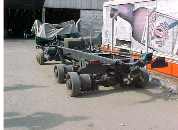
Chassis Mercedes Benz civil 6x6 importado da Alemanha que é base do caminhão Tectran do Astros II no pátio da empresa em 2002. (Fotos: autor)
