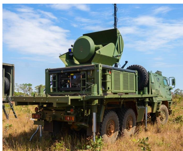
Sistema de Controle de Tiro e Rastreamento Fieldguard 3 Fire Control da empresa alemã Rheinmetall. (Fotos: Rheinmetall)
