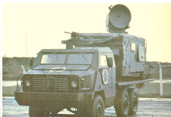
Primeira versão do Astros II (Brucutu), veículo lançador e diretora de tiro. (Fotos: catálogos Avibrás – coleção autor)
